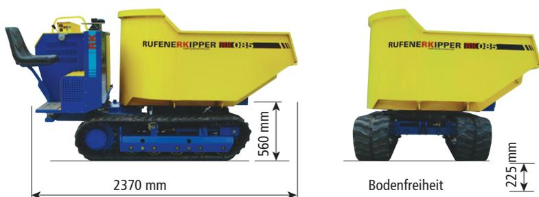
Beachten Sie die kompakte typische Bauart der RUFENERKIPPER. Grosse und tiefliegende Mulde, kurzer Motoranbau und Bedienerteil. Sitz leicht entfernbar.
