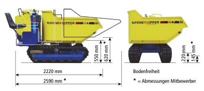
Beachten Sie die kompakte typische Bauart der RUFENERKIPPER. Grosse und tiefliegende Mulde, kurzer Motoranbau und Bedienerteil. Sitz leicht entfernbar. Zum Vergleich haben wir noch die Abmessungen eines in etwa vergleichbaren Mitbewerbermodels eingetragen.
