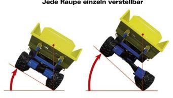
Die neuen Modelle sind sehr geländetauglich geworden. Die Spurbreitenverstellung erfolgt hydraulisch leicht schräg nach unten. Damit werden durch einseitiges Verstellen des Fahrwerks Schräglagen im Gelände ausgeglichen und gleichzeitig gewinnt der Raupenkipper an Bodenfreiheit.
